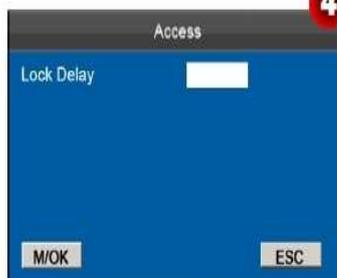
**Lock Delay:** Indica el tiempo durante el que el dispositivo para colocar la cerradura eléctrica en el estado abierto. (Alcance Valor: 1 ~ 10 segundos)
