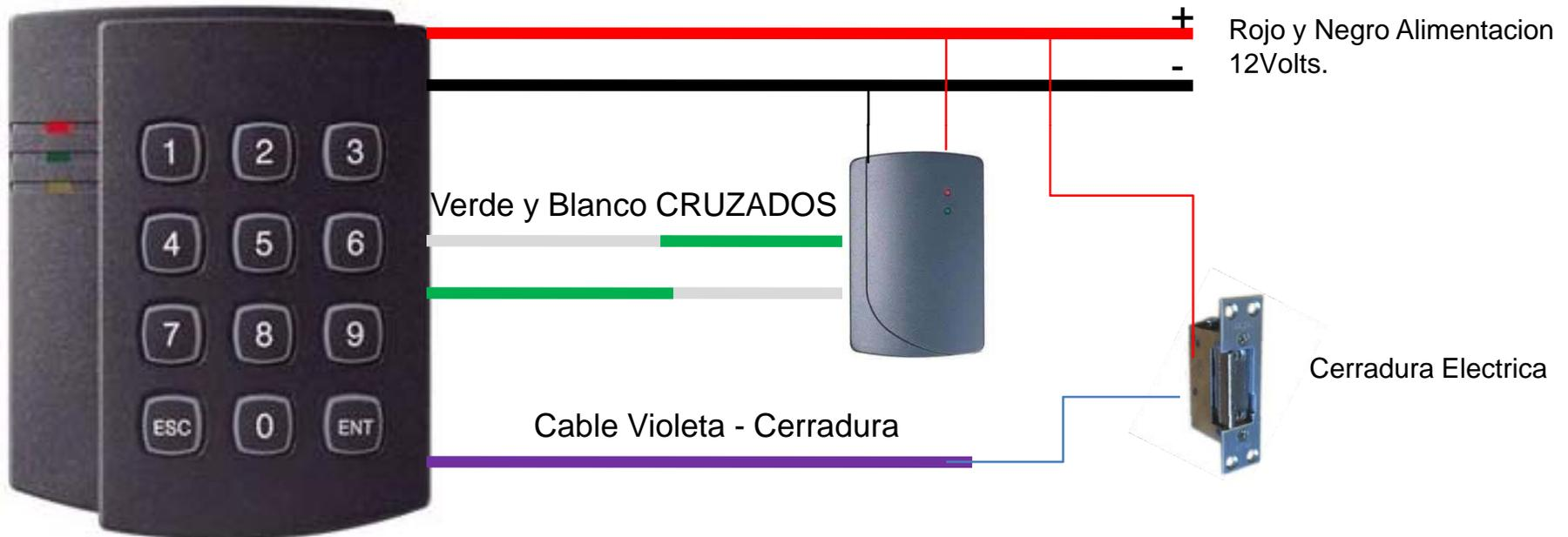
En este caso se utiliza el controlador para ingreso con tarjeta/clave o tarjeta + clave
