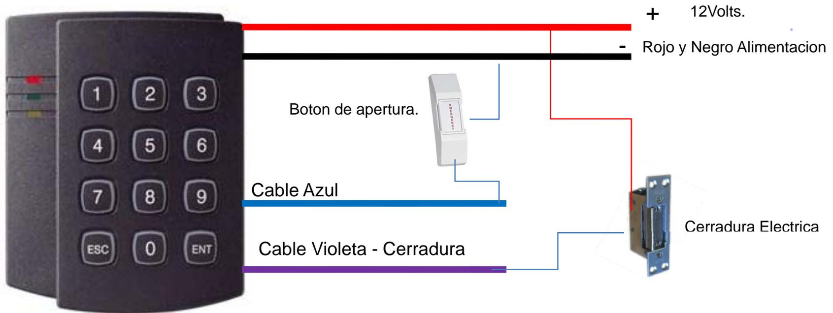
En este caso se utiliza el controlador para ingreso con tarjeta/clave o tarjeta + clave
