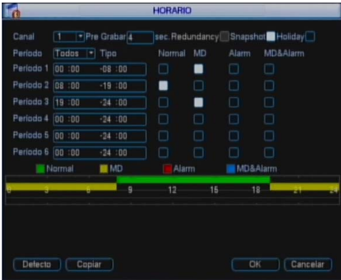
Imagen 3 - Detección de movimiento y Grabación continua en diferentes franjas horarias.
