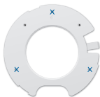
Agujeros de soporte de montaje (3) para el UAP-PRO
